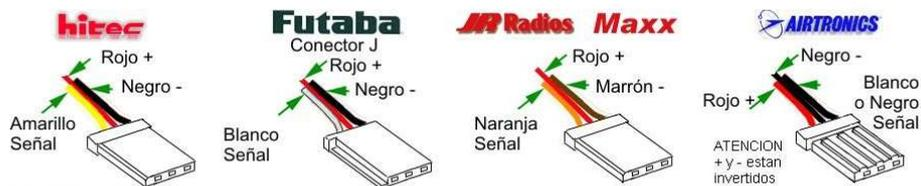
Figura 3 - Esquema de conexión eléctrica de los servos
